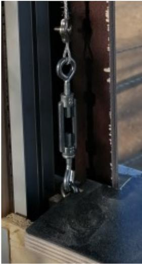
es notwendig, dass die Platten frei hängen können. Gezogen werden die Wände von 3mm Stahlseil, welches über die Gurtscheiben auf der oben angebrachten Welle angetrieben wird. Ein Spannschloss zwischen Stahlseil und Platte ermöglicht eine Feinjustierung, um die Platten gerade laufen zu lassen.
